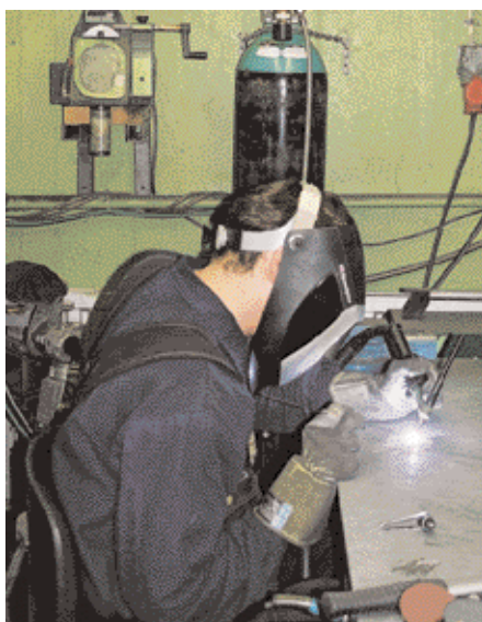
Att svetsa produkter som innehåller magneter innebär svårigheter. Svetsarna på Sundab har utvecklat en väl fungerande teknik för detta.
