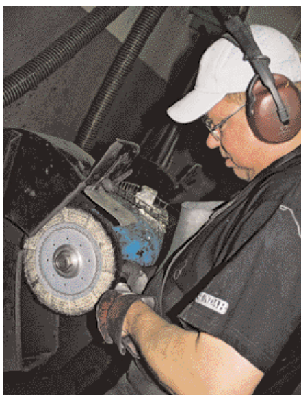
Slipning och polering är en viktig del i tillverkningen. Här behövs skickliga hantverkare för att nå det sista optimala som maskinerna inte klarar.
