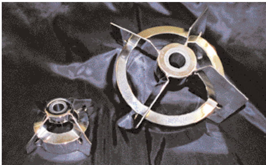
Magnetomrörare med keramiska lager.
